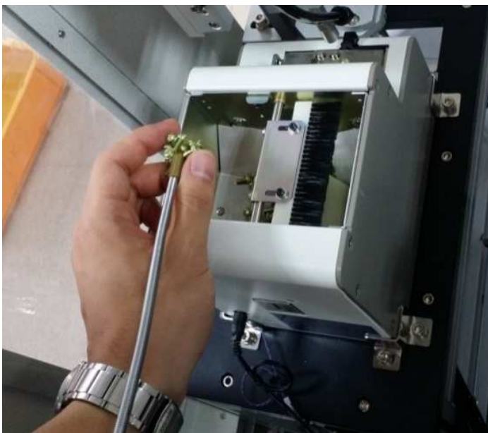
3. 남은 볼트는 Magnetic을 이용하여 내부 및 외부로 돌출한 부분까지 제거를 한 후 작업 할 볼트를 1/3만 채워 넣는다.
