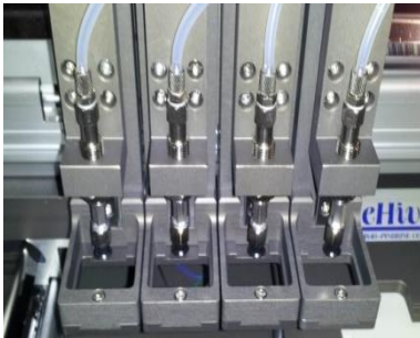
Press Jig 장착 완료
